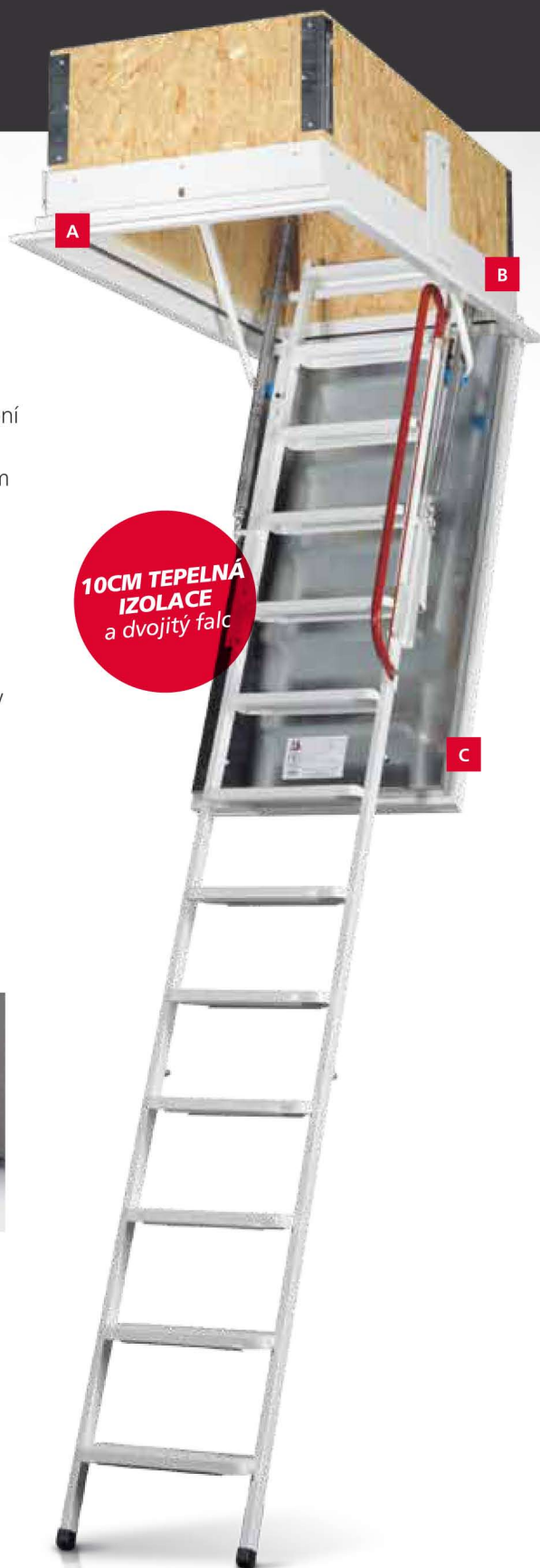
Spodní víko s dvojitým falcem, 10cm izolace a dvojitě těsnění
